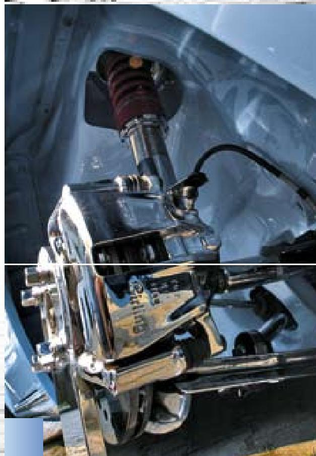
**Erststrangig:** Sogar die Girling-Sättel der Scirocco 16V-Bremsanlage und das Fahrwerk sind verchromt
