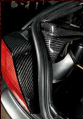
**Selbst Kleinigkeiten wie die Gehäuse der roten Rückleuchten durften sich dem angesagten Kleiderzwang nicht entziehen**
