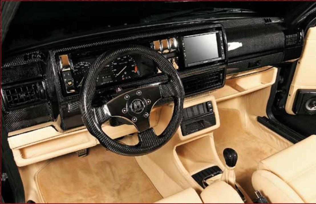
Oben: Mit Kohlefaser überlaminiertes Armaturenbrett. Die Ablagefächer darunter sind mit Leder bezogen Unten: Geteilte Rücksitzbank mit Kohlefaserverkleidung Rechts: Kompromisslos geglätteter Motorraum, verdeckt geführte Kabelbäume
