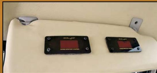
Batterie-Anzeige in der Beifahrer-Sonnenblende, Bedienteil fürs Radio beim Fahrer
